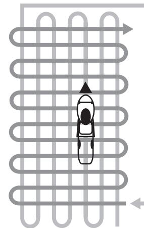
**Рис. 8 Схема скашивания высокой и/или загущенной травы**
