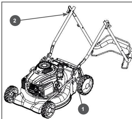
**Рис. 2 Установка рабочей рукоятки в рабочее положение**
